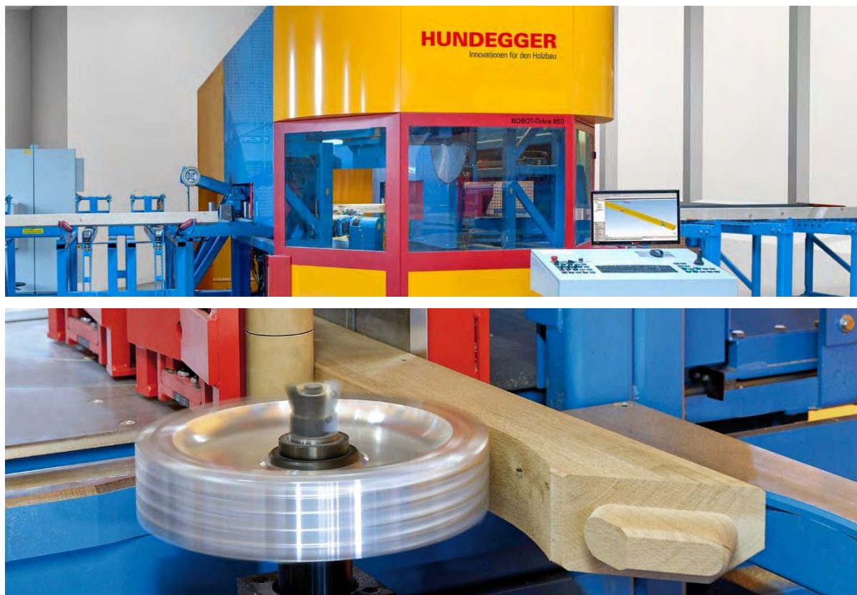
Puurakenneosien valmistusta automaatiolinjalla. Kuvat Hundegger GmbH.
