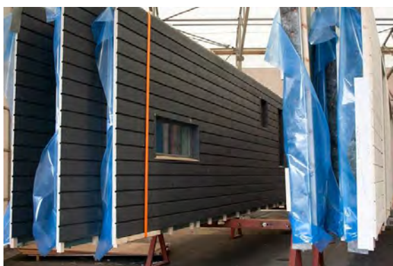
Valmiita suurelementtejä kuljetettavaksi työmaalle, kuvat Jukkatalo Oy.
