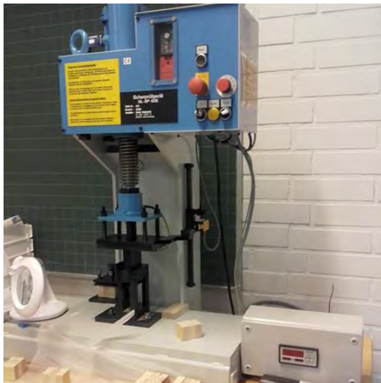
Liimasauman leikkauslujuuden testilaite Kuvat Ammattiopisto Lappia
