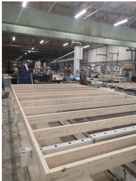
Elementin rungon kokoaminen elementtipöydällä, kuvat Jukkatalo Oy
