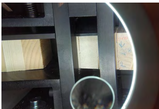
Liimasauman leikkauslujuuden testilaite Kuvat Ammattiopisto Lappia
