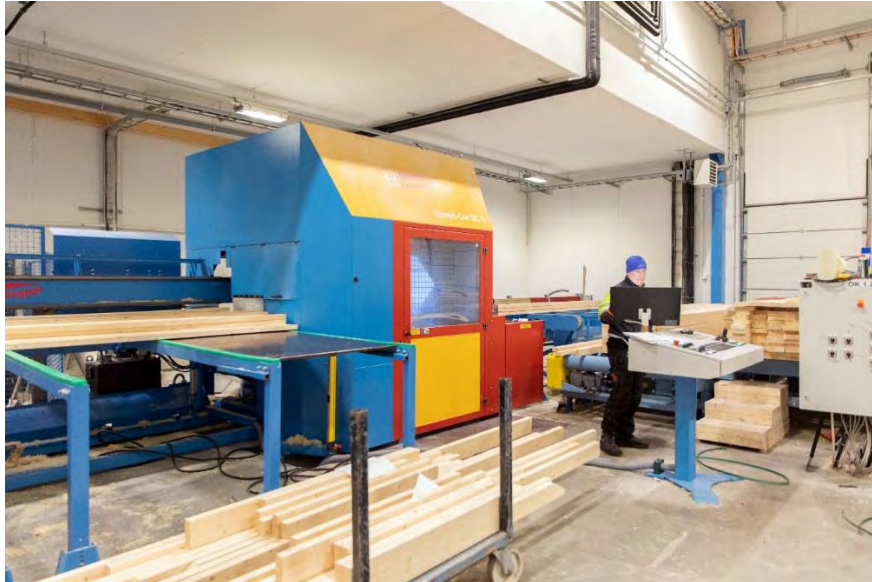
Ristikkosauvojen valmistus tietokoneohjatulla linjalla, kuva Keminmaan Puurakenne Oy.
