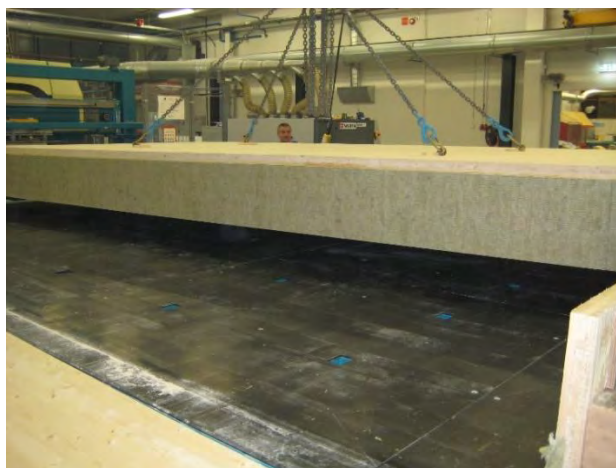
CLT-elementtien nostoja tehtaalla. Kuvat Ammattiopisto Lappia
