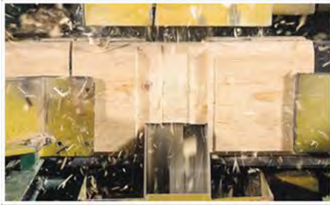
Pitkänurkkasalvoksen työstöä, kuva Kontiotuote Oy
