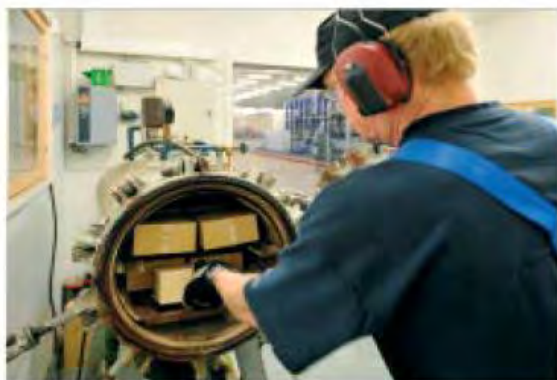
Delaminoinnin painekattilavaihe, kuva Kontiotuote Oy.
