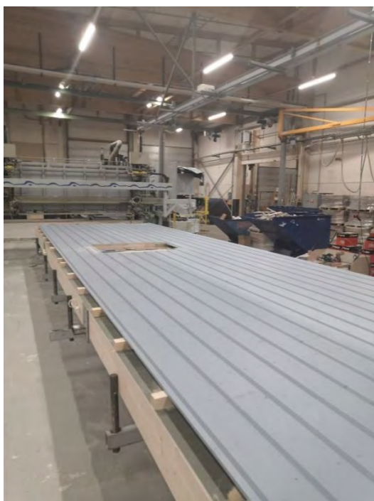
Ulkoverhouspaneelit asennettuina elementtiin, kuvat Jukkatalo Oy.
