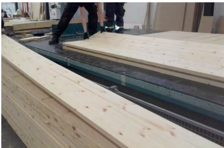
CLT-levyn käsinaldonta. Kuvat Ammattiopisto Lappia.
