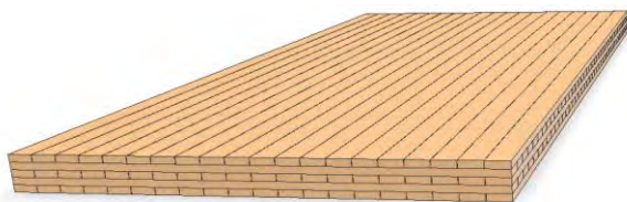
CLT-levy (lamellit ristiin liimattu)
