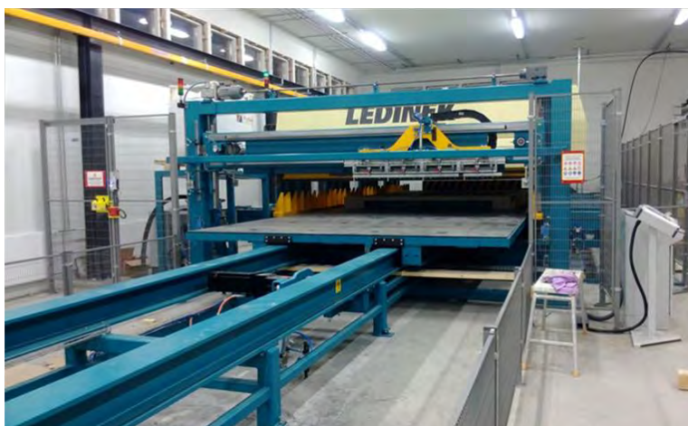
CLT-levyn valmistukseen käytettävä puristin
