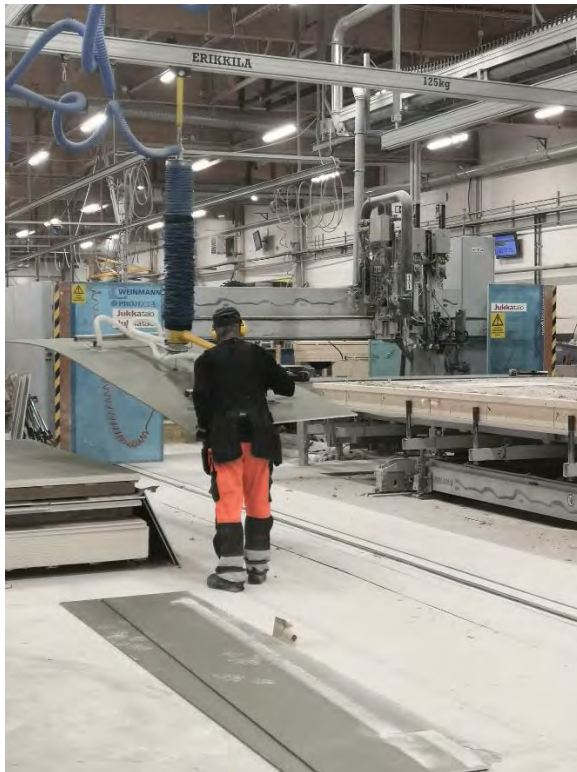
Levyjen siirtoa elementtipöydälle, kuvat Jukkatalo Oy
