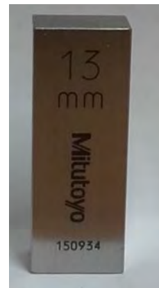
Vaa'an virallinen testipunnus, työntömitta ja työntömitan virallinen kalibrointipala. Kuvat Ammattiopisto Lappia.
