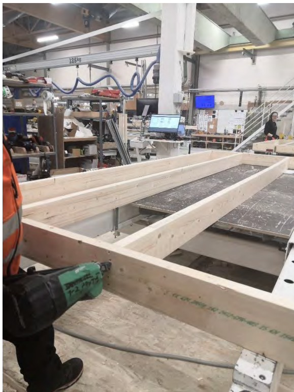
Elementin rungon kokoaminen elementtipöydällä, kuvat Jukkatalo Oy
