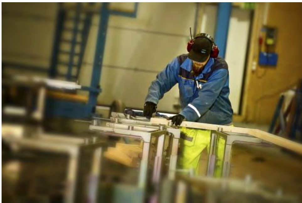
Naulalevyjen puristus, kuva Keminmaan Puurakenne Oy.
