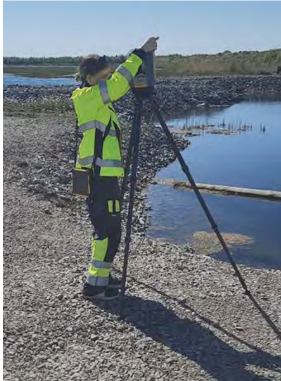
Laserkeilaimen asettaminen telineeseen, kuva Proinse Oy.
