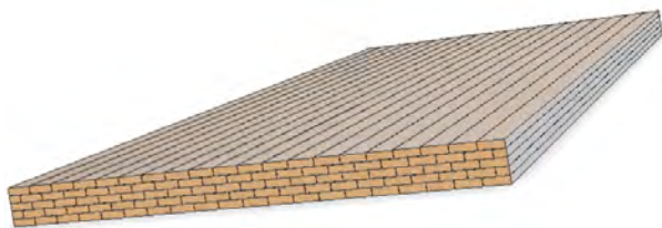
GLT-levy (lamellit samaan suuntaan liimattu) Lamellit limitetään kerroksittain
