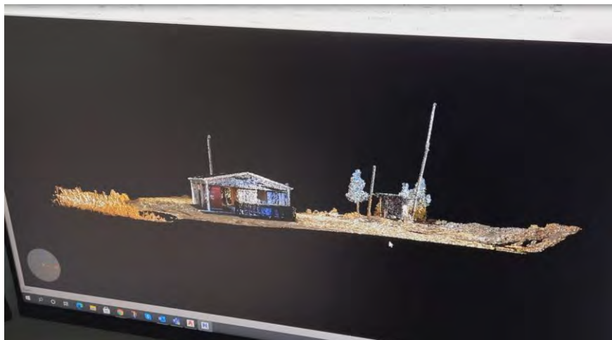
Laserkeilaimella luotu pistepilvi, kuva Proinse Oy.
