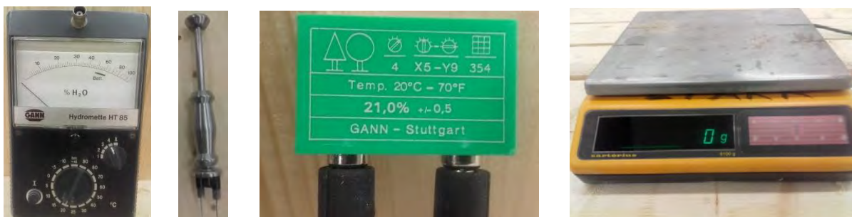
Puunkosteusmittari, Gann M 18 juntta-anturi, puunkosteusmittarin kalibrointilaite ja mittauksessa käytettävä vaaka. Kuvat Ammattiopisto Lappia.
